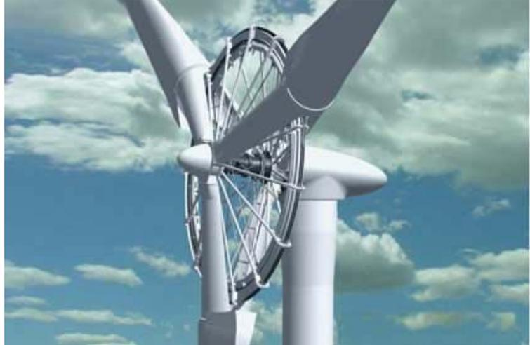
由三个倒等距 V 型叶片支撑结构夹住中央的发电机，提高了整体的刚性和稳定性。变桨轴承安装位置离转子中心 15 m。该公司首席技术官 Eystein Borgen 指出，直接将叶片、叶片支撑结构和发电机耦合起来的设计益处之一是具有较短的荷载路径，使得发电机气隙不受前后向不断变动的风力荷载的影响；另一个益处是转子平面的转子扭矩和叶片重力荷载平均分布并被整体结构吸收。
